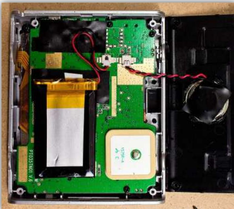
Zum Schließen des Gerätes wieder alle Kabel verbinden. Es sollte so wie in der nebenstehenden Abbildung aussehen.
