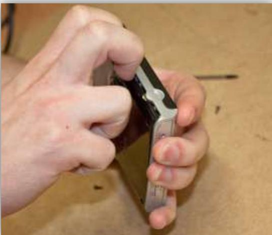
Nach dem lösen der Schrauben kann der Deckel nun abgenommen werden. Hierfür stellt man das Gerät am besten hochkant mit dem runden Power-Schalter nach oben ausgerichtet. Anschließend nun mit den Fingernägeln das Gerät kräftig aber ohne Gewalt öffnen. An den Seiten sind auch noch Verankerungen.
