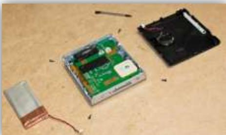
Damit wäre der Ausbau des alten Akkus erledigt. Auf der nächsten Seite geht es weiter mit dem Einsetzen des neuen Akkus in das Gerät.
